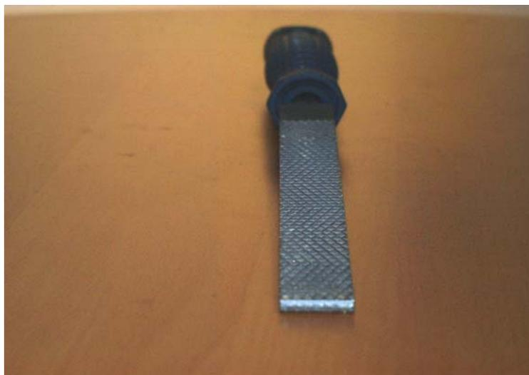
Mit der Flachraspel werden gerade und schräge Kanten bearbeitet.
